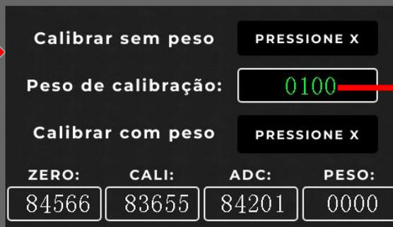
Insira um peso conhecido na máquina e digite o peso com **+** e **-**. Pressionando **X** são adicionados 100 Kg. Avance para “Calibrar com peso” usando **↩**.
