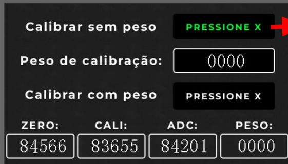
Com a máquina vazia, pressione **X**. Aguarde, e tecla **↩** para avançar para “Peso de calibração”.
