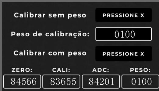
Com o objeto na máquina, pressione **X** e aguarde o PESO se estabilizar.
